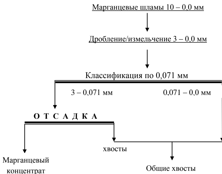
Рисунок 22– Гравитационная схема переработки марганцевых шламов с использованием процесса отсадки класса 3 – 0,071 мм
