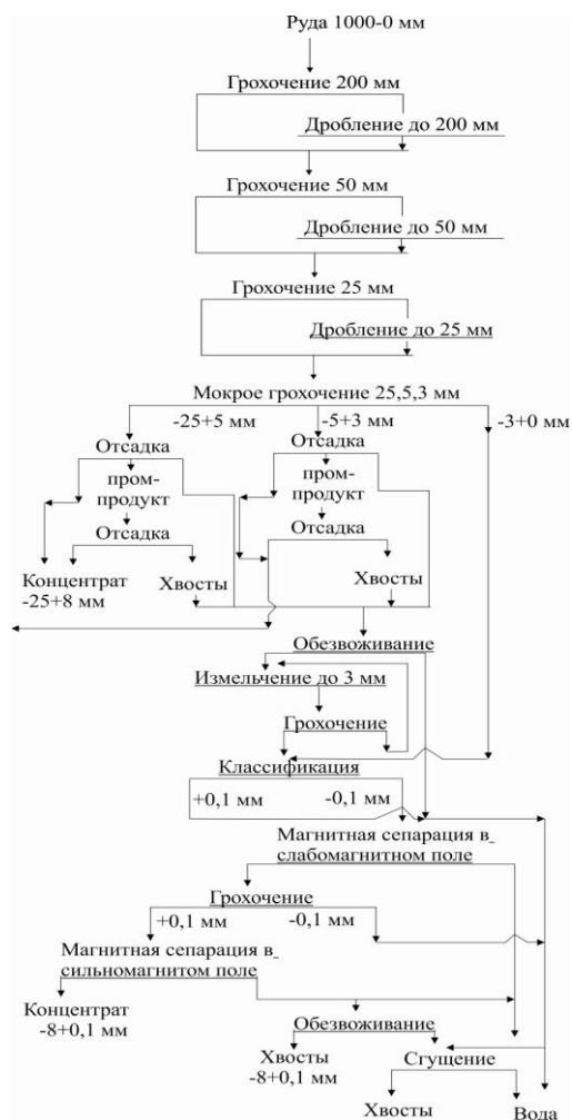
Рисунок 2 - Технологическая схема обогащения маложелезистой первичной марганцевой руды месторождения “Ушкатын-III”,
